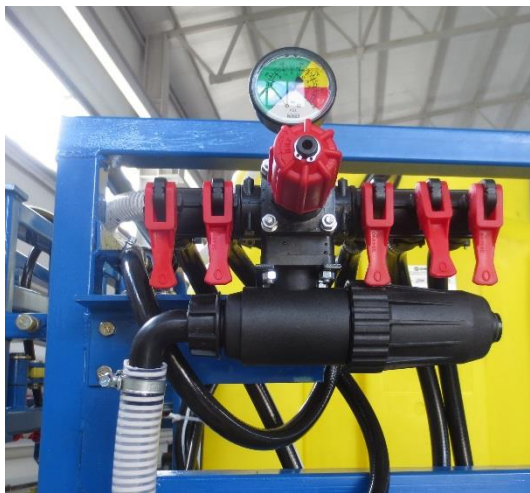
Рис.10 Распределитель 5-ти секционный
